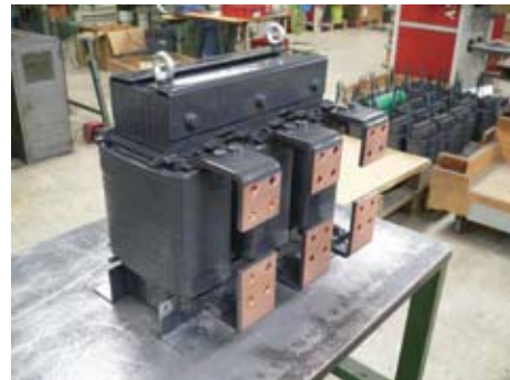
Hochstromdrossel 2.500 A mit Kupferlaschen-Anschluss
