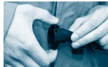
Rastnasen nach innen drücken (NORDUC® Montagesystem wieder einsatzfähig) Push the detent lugs in (NORDUC® assembly system ready to use again)
