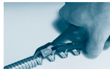
Überstehendes Profil mit Bleischere oder Zange abtrennen. Cutting of the protruding profile with a shear blade or diagonal cutting pliers.
