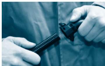
Wellschlauch aus Verschraubung ziehen Pull the corrugated tube out of the connector
