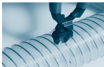
Stützwendel mittels Zange durchtrennen. Intersect the supporting spiral with pliers.
