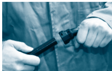
Schlauch in „geschlossene“ Verschraubung bis zum festen Anschlag einstecken (Montage der Verschraubung) Insert the tube into the „closed“ connector as far as it will go (to assemble the connector)
