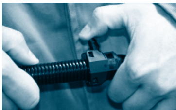
Rastnasen nach außen schwenken (Demontage der Verschraubung) Move the detent lugs out (to dismantle the connector)
