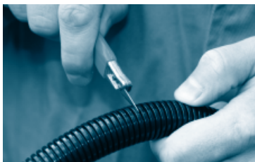
Schlauch auf einem Wellenberg trennen (optimale Erzielung der Schutzart Schlauch und Verschraubung) Separate the tube at a corrugation crest (optimal protection of the tube and connector)
