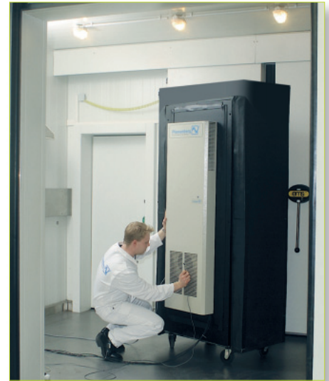
Labortest zum Einsatz von CO 2 als Kältemittel in Pfannenberg Klimatisierungsgeräten.
