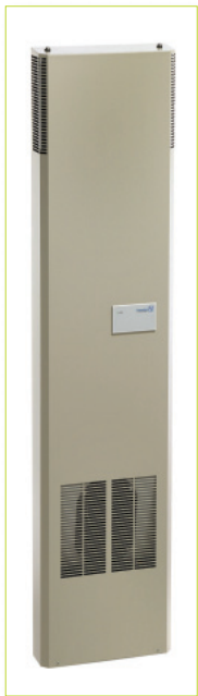
Das bei tesa erprobte CO 2 -basierte Kühlgerät ist eine Sondervariante des Pfannenberg DTI 9441 Kühlgeräts für den teilversenkten Tür- oder Seiteneinbau mit einer Kühlleistung von zwei kW. Die Prototypen-Bezeichnung lautet «DTI 9441 CO 2 ».
