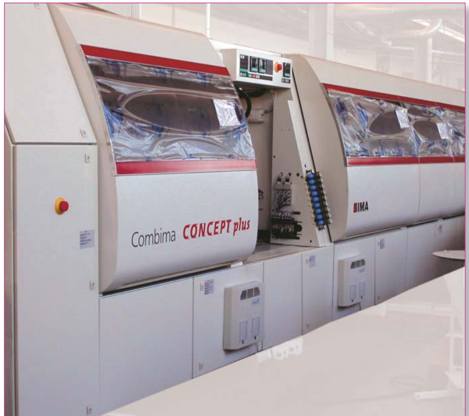
Maschinenintegrierte Schaltschränke können als tragende Elemente verwendet werden
