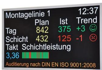
*Das ProScreen-System umfasst Industriemonitore und ermöglicht dem Nutzer über die Software ProView die individuelle Erstellung von dynamisierten Bildinhalten, sowie die Steuerung von Prozessen.*
